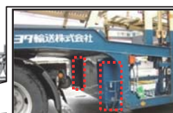
②電動油圧ユニット デッドスペースのNo.57ロア前方を利用
